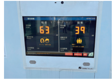
騒音・振動モニター
